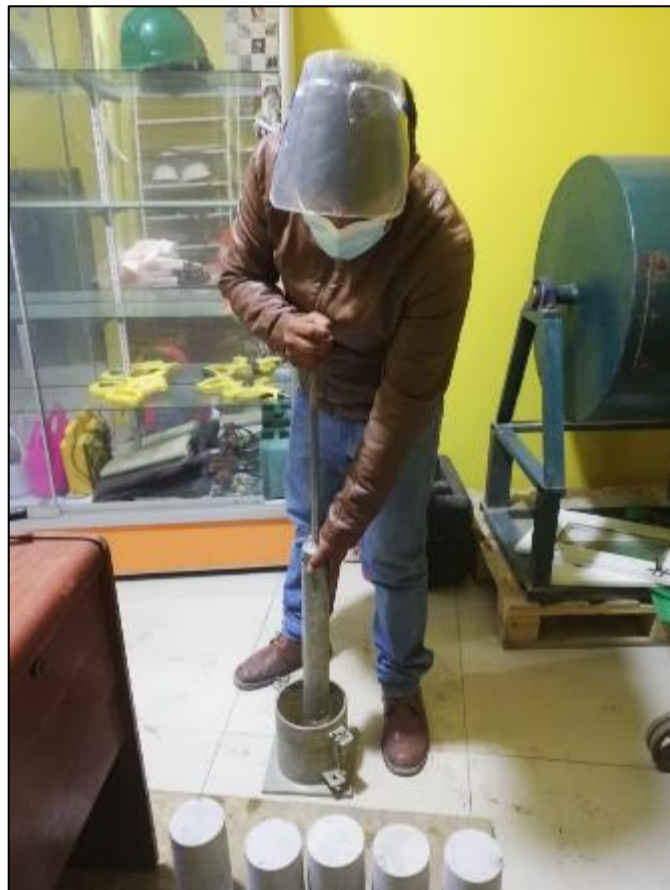
Fotografía 11. Ejecución del ensayo de Proctor.
