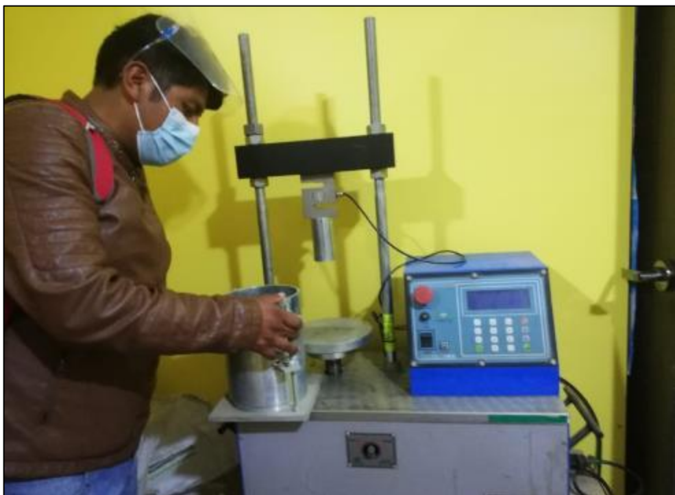
Fotografía 13. Preparación de muestra para el ensayo de CBR.
