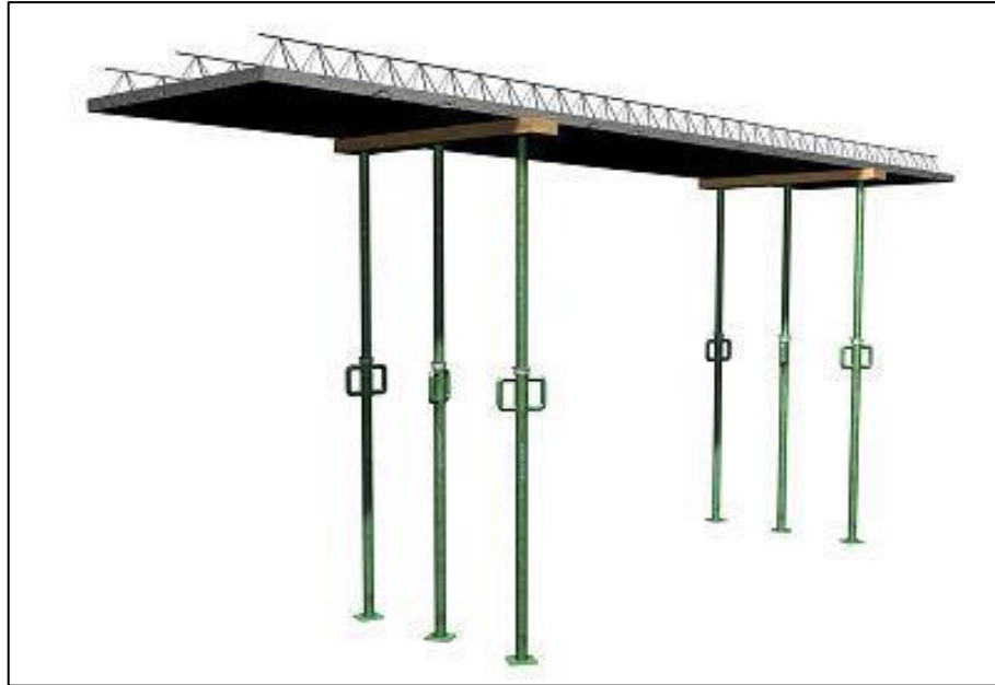
Figura 41: Apuntalamiento de prelosa
