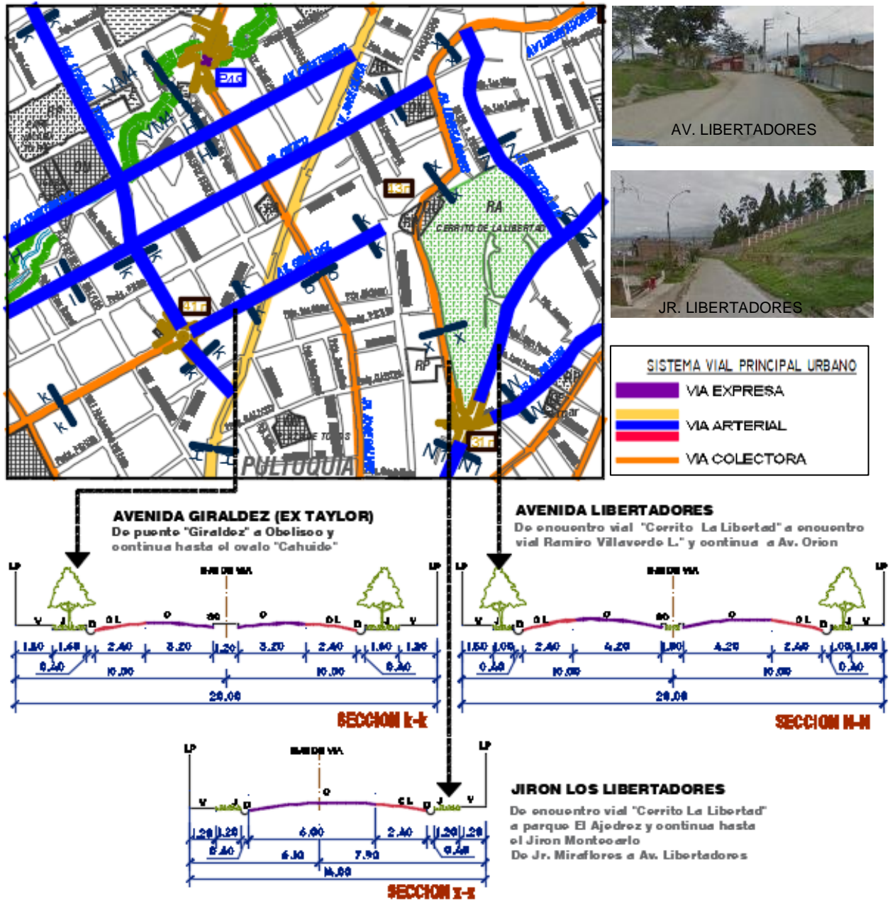
Figura 63. Estructura urbana del terreno – sistema vial.
