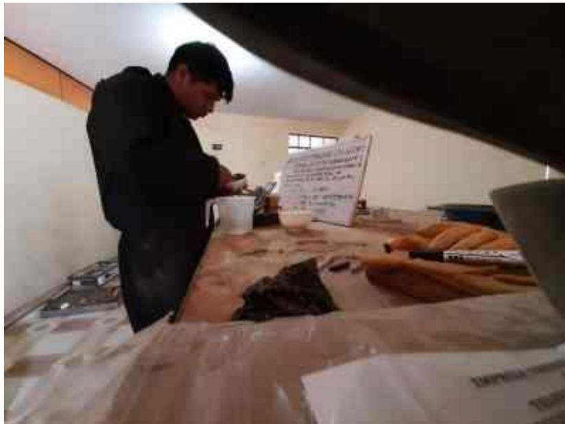
Fotografía 12: Ensayo de Limite Liquito, Limite Plástico de la calicata C-1 KM 5+900 a 4% de Bischofita.
