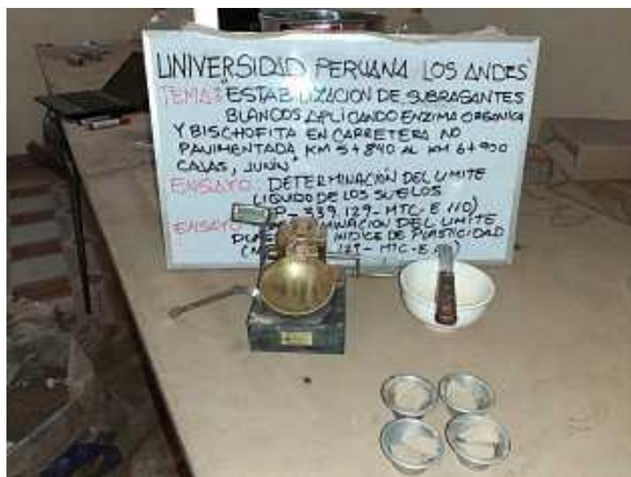
Figura 16: Equipos para el ensayo Limite Líquido y Limite Plástico
