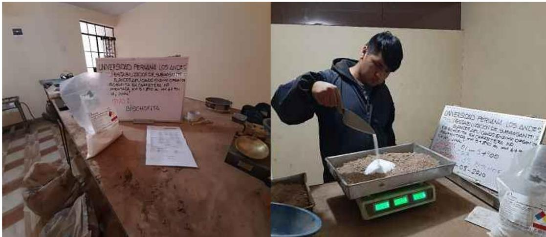
Figura 31: Proporción del Aditivo Estabilizante Bischofita
