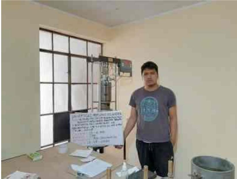
Fotografía 19: Ensayo de CBR de la calicata C-3 KM 6+900 a 5% de Bischofita.
