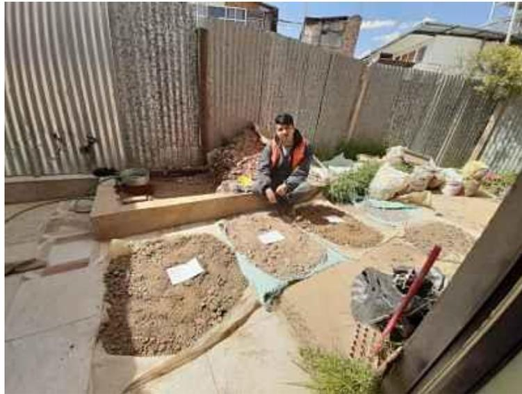
*Figura 29: Secado de material de las calicatas C-1, C-2 y C-3*
