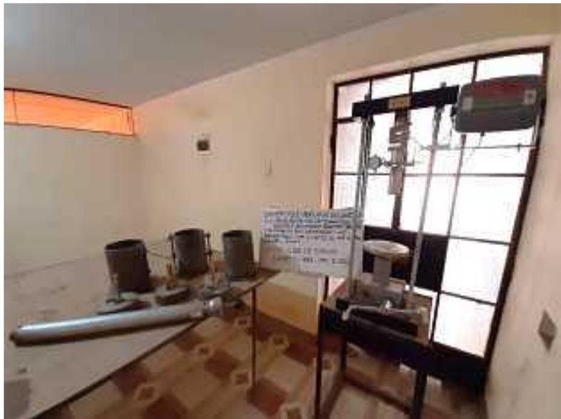
Figura 19: Equipos para el ensayo de CBR.
