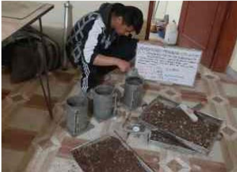
Fotografía 15: Ensayo de CBR de la calicata C-3 KM 6+900 a 4% de Bischofita.
