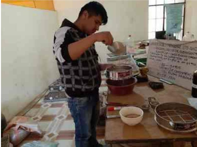
Fotografía 9: Tamizaje de la muestra del suelo para los ensayos de Límites de Consistencia de la calicata C-1 KM 5+900 a una proporción de 1.5L.
