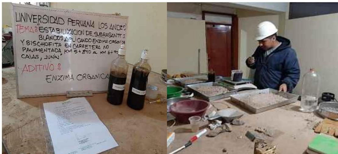
Figura 30: Proporción del Aditivo Estabilizante Enzima Orgánica
