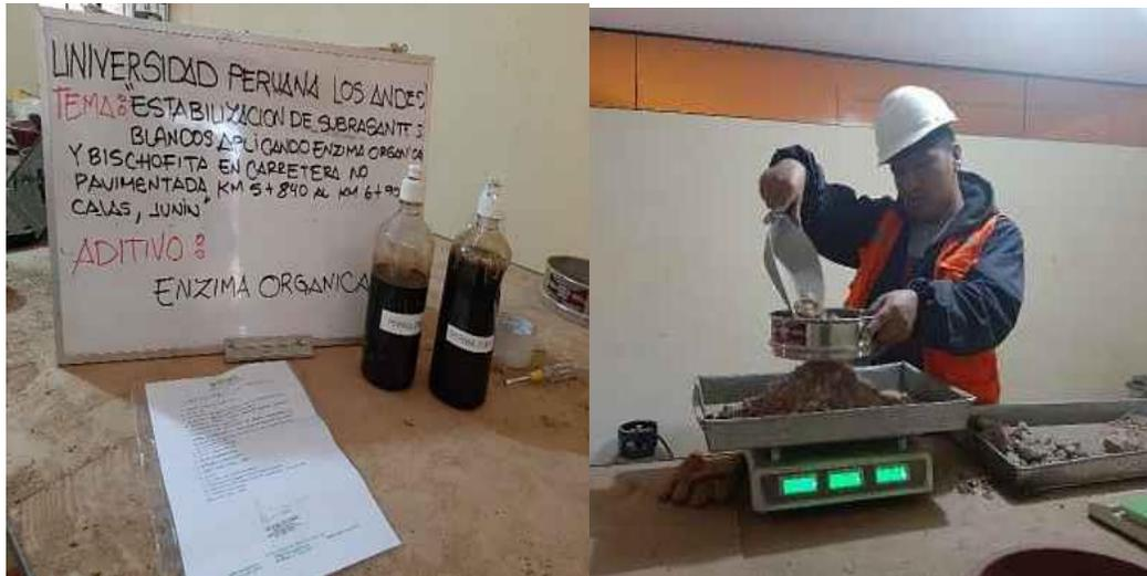
Figura 39: Proporción del Aditivo Estabilizante Enzima Orgánica
