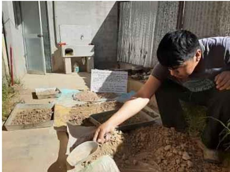
Figura 38: Secado del material de las calicatas C-1, C-2 y C-3
