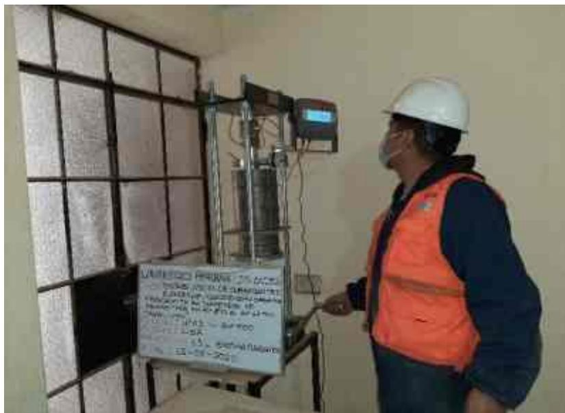
Fotografía 18: Ensayo de CBR de la calicata C-3 KM 6+900 a 1.5L Enzima Orgánica.
