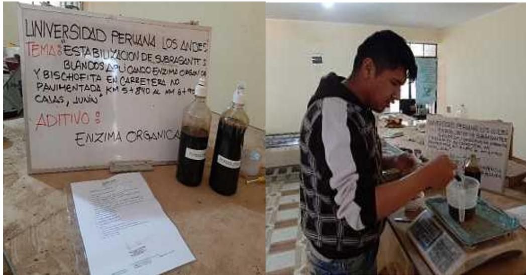
Figura 21: Proporción del Aditivo Estabilizante Enzima Orgánica
