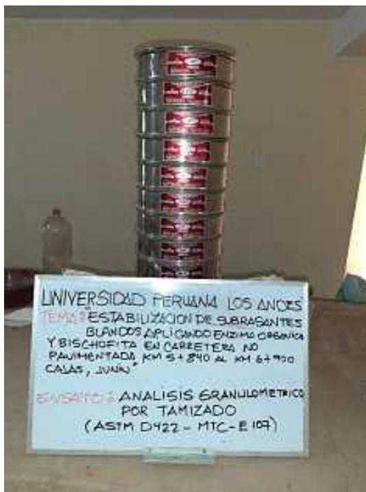
Figura 15: Equipo para el ensayo de Granulometría
