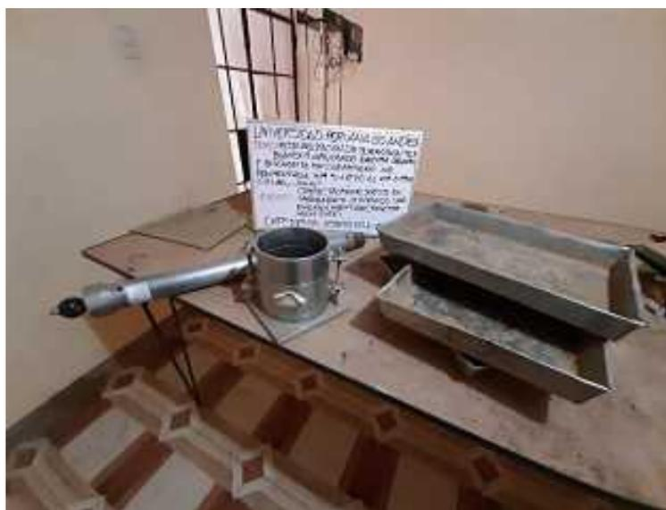
Figura 17: Equipos para el ensayo de Proctor Modificado
