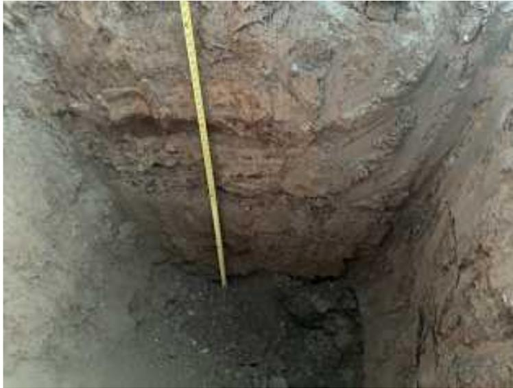
*Figura 14: Perfil Estratigráfico - Calicata N°03 - KM 6+900*
