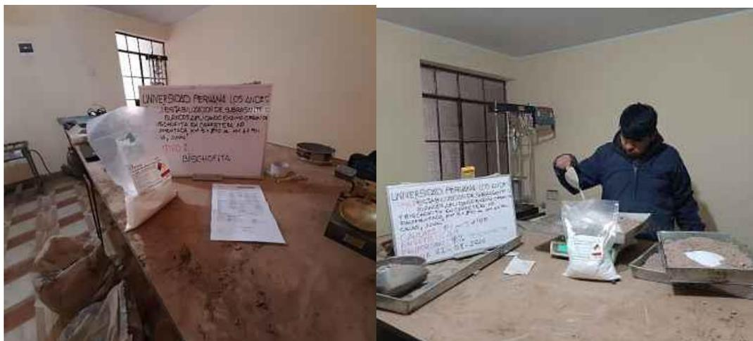
Figura 40: Proporción del Aditivo Estabilizante Bischofita
