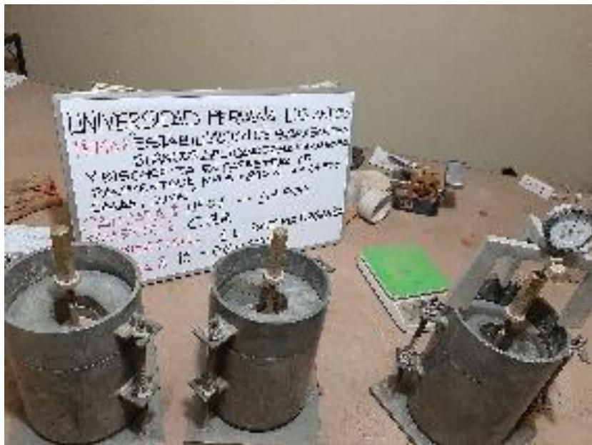
Fotografía 16: Ensayo de CBR de la calicata C-1 KM 5+900 a 1L Enzima Orgánica.
