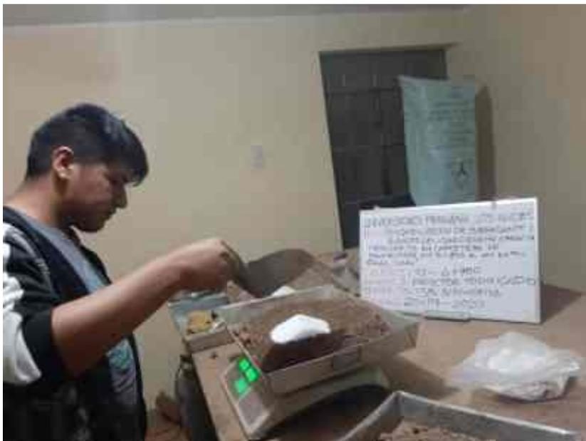
Fotografía 14: Ensayo de Proctor Modificado de la calicata C-3 KM 6+900 a 5% de Bischofita.
