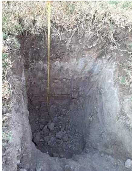
*Figura 10: Perfil Estratigráfico – Calicata N°01 – KM 5+900*
