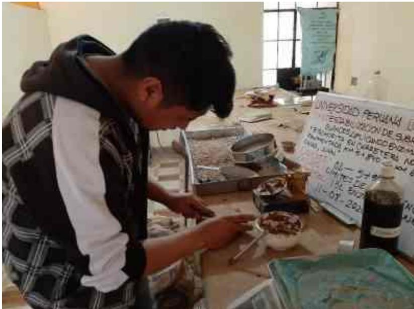
Fotografía 10: Ensayo de Límite Líquido, Límite Plástico de la calicata C-1 KM 5+900 a 1.5L de Enzima Orgánica
