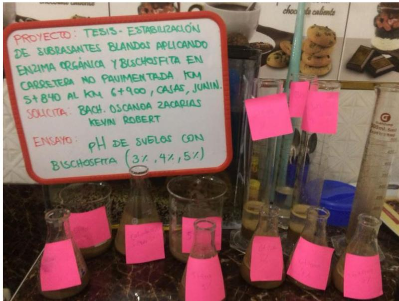
Fotografía 21: Ensayo del pH del Suelo a proporción 3%, 4%, 5% de Bischofita.
