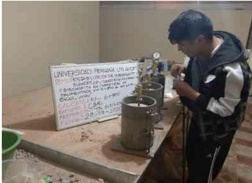
Fotografía 17: Ensayo de CBR de la calicata C-3 KM 6+900 a 4% de Bischofita.
