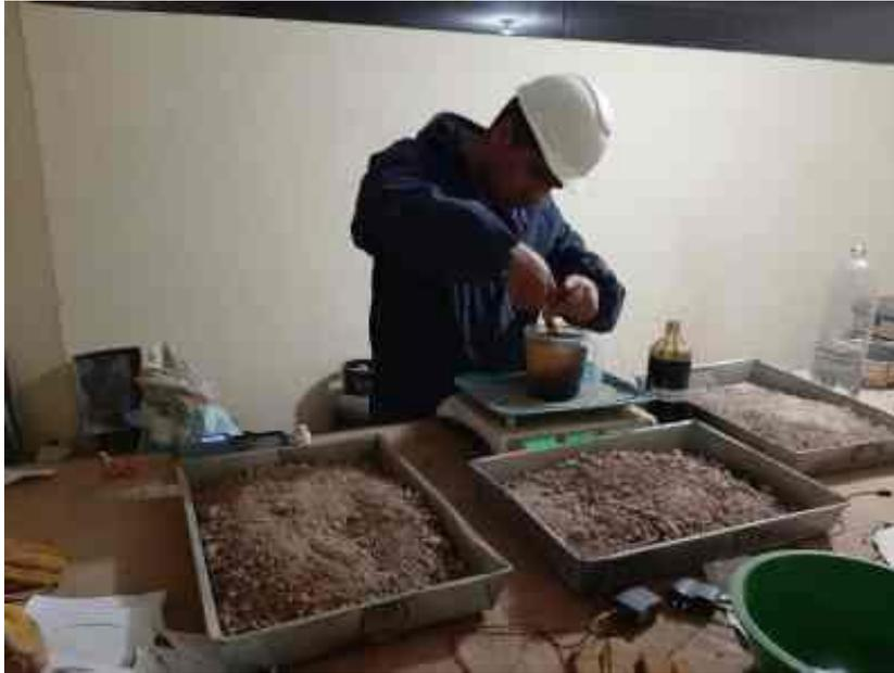
Fotografía 13: Ensayo de Proctor Modificado con Enzima Orgánica.
