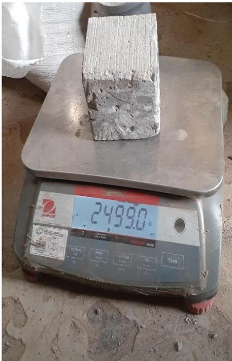
**Figura 8:** Peso de la muestra perfilada
