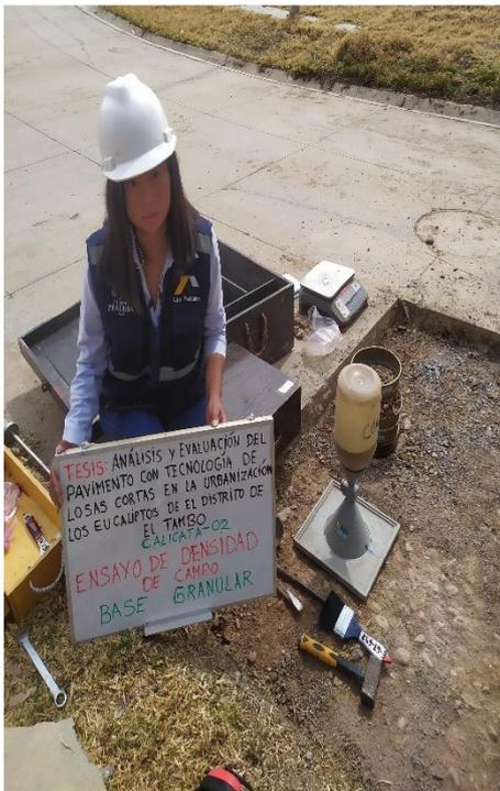
**Figura 10:** Densidad in situ en la base granular
