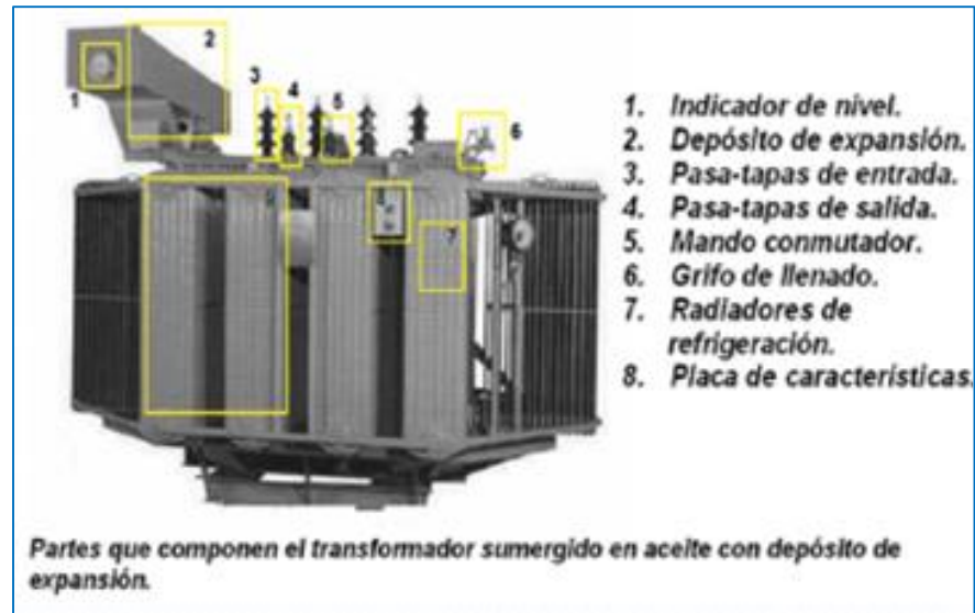
Figura. 2.8 Transformador de Potencia 25MVA
