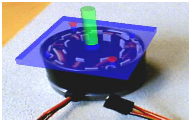
FIG. 7: Vue augmentée de l'opérateur après un "Adding". L'expert montre par une animation virtuelle 3D calée sur l'élément réel le montage final.
