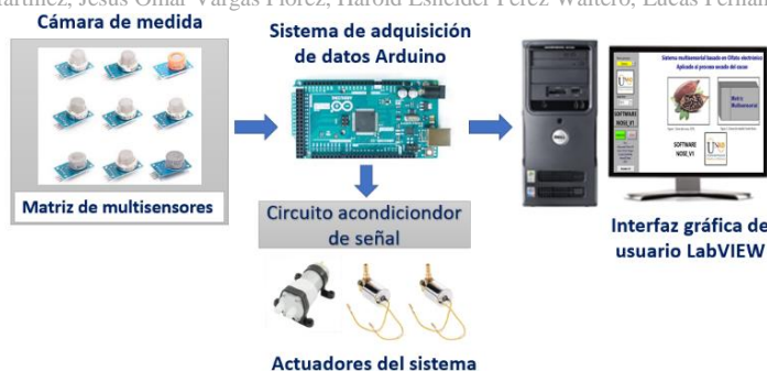
Figura 4: Sistema de olfato electrónico para adquisición de volátiles de muestras de cacao seco. Fuente: Elaboración propia.
