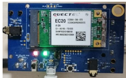
Figura 8: Módulo celular para puerta de enlace Gateway. Fuente: Elaboración propia.
