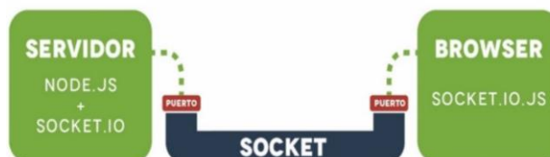
Figura 3: Tráfico de datos a la web mediante conectores web. Fuente: Elaboración propia.
