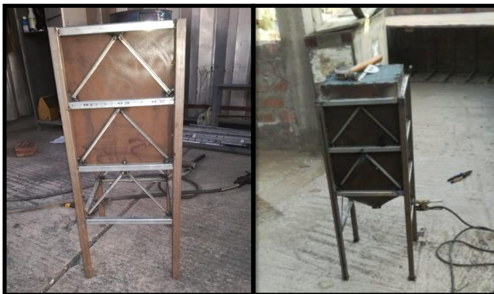
Figura 24. Estructura de tolva principal
