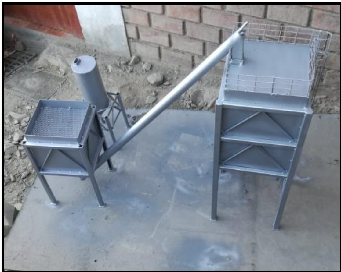
Figura 28. Estructura de tolvas y sistema de acarreo
