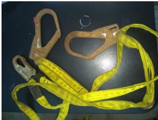
Figura 15. Línea de vida con corrosión
