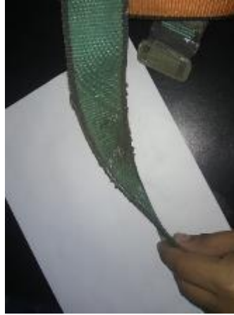
Figura 12. Arnés presenta cortes y desgaste
