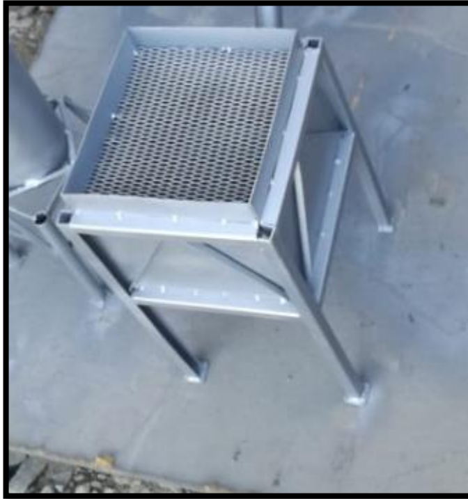
Figura 26. Estructura de tolva de abastecimiento
