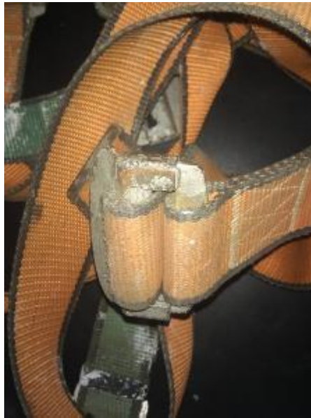
Figura 14. Elementos metálicos con corrosión.
