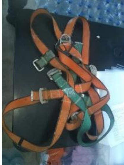
Figura 13. Hilos y costuras del arnés de seguridad en mal estado.
