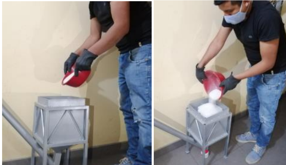
Figura 31. Abastecimiento de la estructura de la tolva
