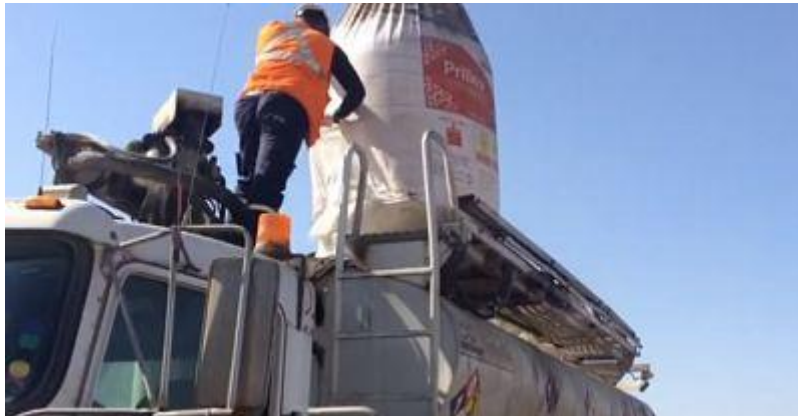
Figura 37. Operador corta el big bag para abastecer el camión cisterna
