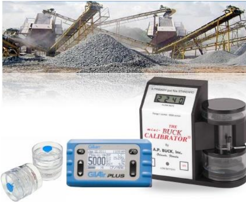
Figura 1 Bomba de muestreo de flujo constante, Calibrador, manguera de conexión, ciclón, medio filtrante, soporte de filtro.
