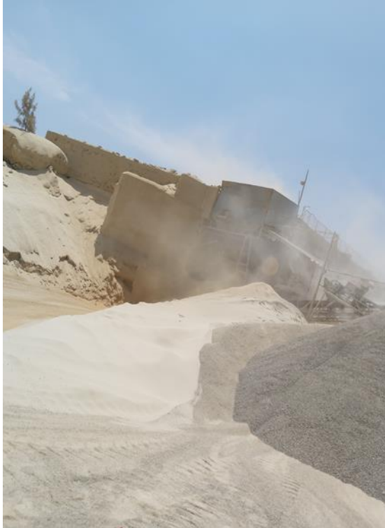
Figura 31 Fuente de emisión: Trituración en la mandíbula primaria
