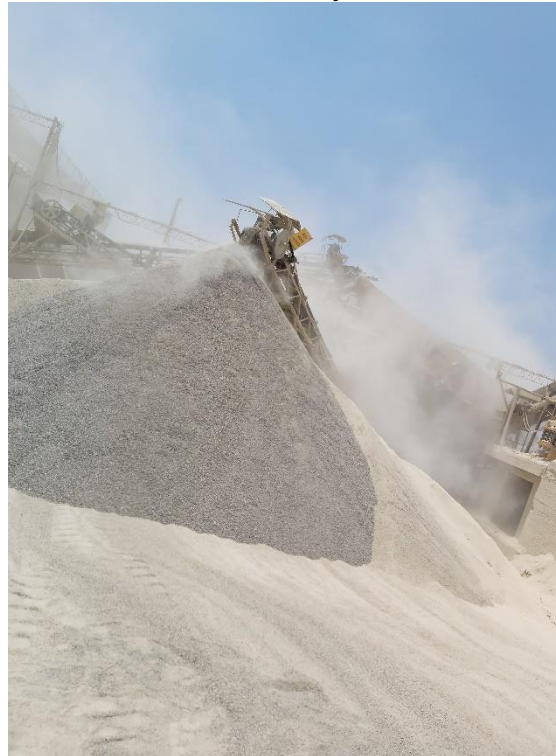
Figura 34 Fuente de emisión: Zaranda y cambios de nivel de flujo del material
