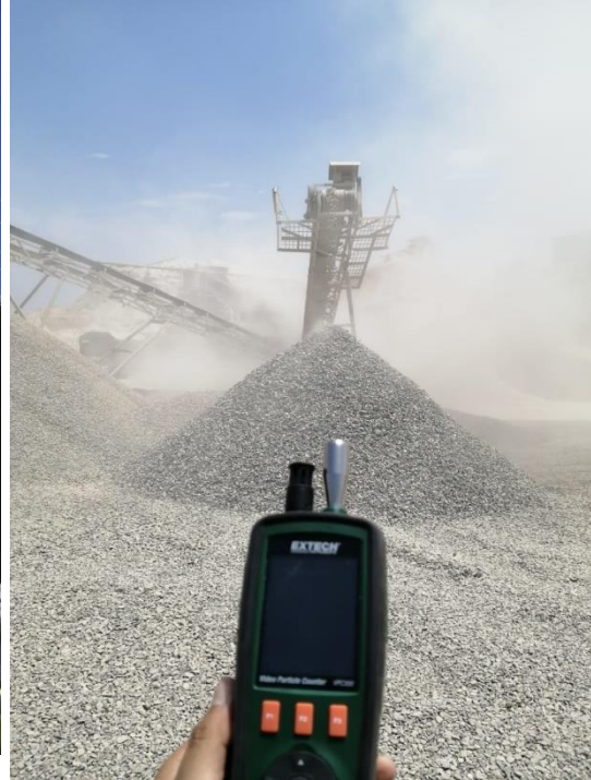
Figura 30 Monitoreo de partículas menor a 5.0 micrómetros
