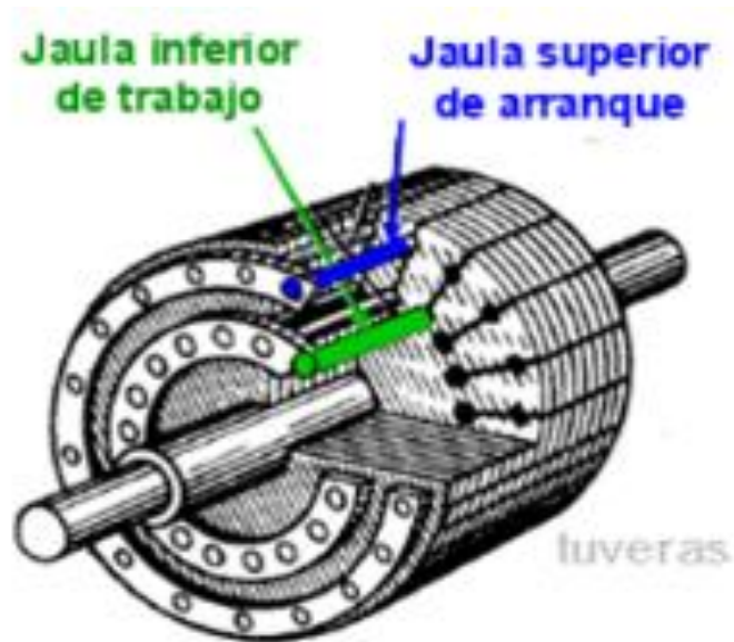
Figura 7. Rotor de doble jaula de ardilla Fuente: Cortes Cherta, 1994
