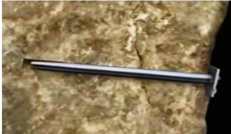
Figura 3. Split set; perno de anclaje. Fuente: Fuerza Minera
