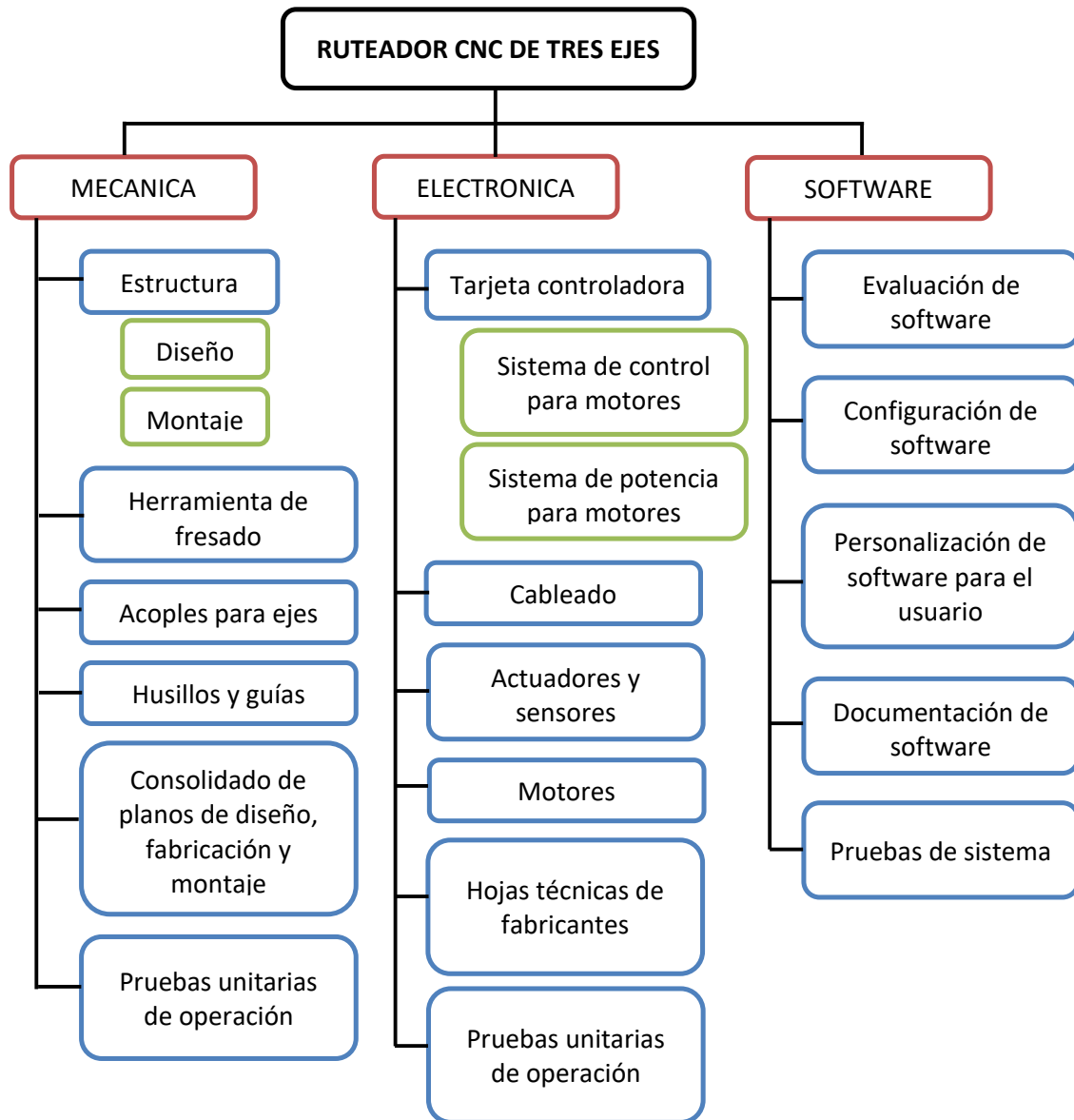
Figura 17. Partes de un ruteador y sus actividades
