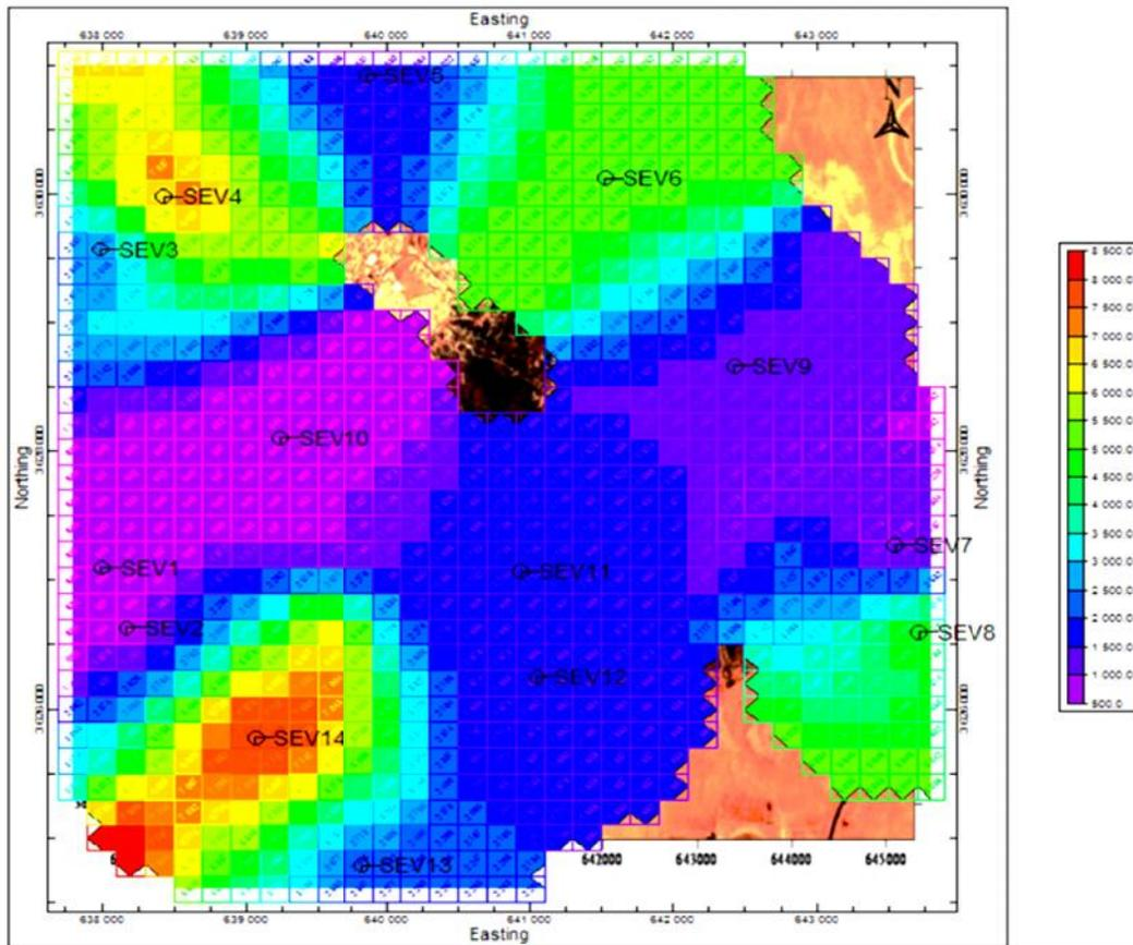
Fig.3. Résultats des sondages électriques site N°1
