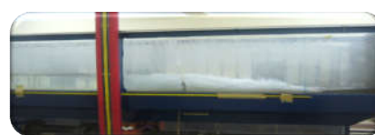
photo10: Photographie d'un ressaut hydraulique
