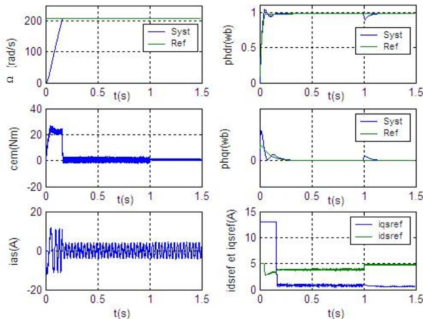
Figure 5 : Comportement dynamique de la MAS lors d'un démarrage avec variation paramétriques
