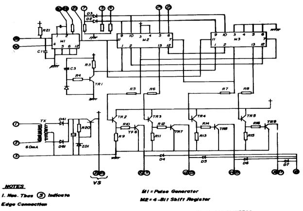
FIG. 2 THE STEPPING MOTOR DRIVE CIRCUITRY
