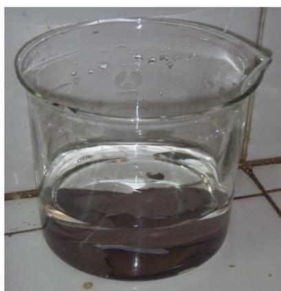
**Photo 2** : Etat limpide des eaux traitées avec des os calcinés à des températures entre 100 et supérieures à 400 °C
