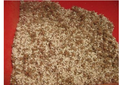
Figure 4 : Mélange de polystyrène et des coques de cotonnier broyé
