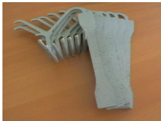
Figure 11 : Eprouvettes de traction injectées avec dispositif d'injection
