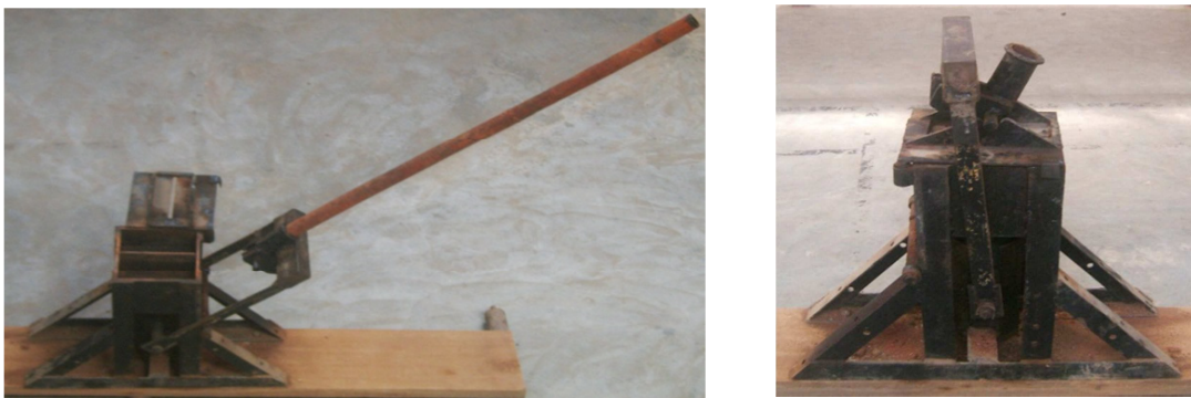
Figure 10 : Différentes vue de la presse de fabrication locale de type Cinva – Ram à étalonner
