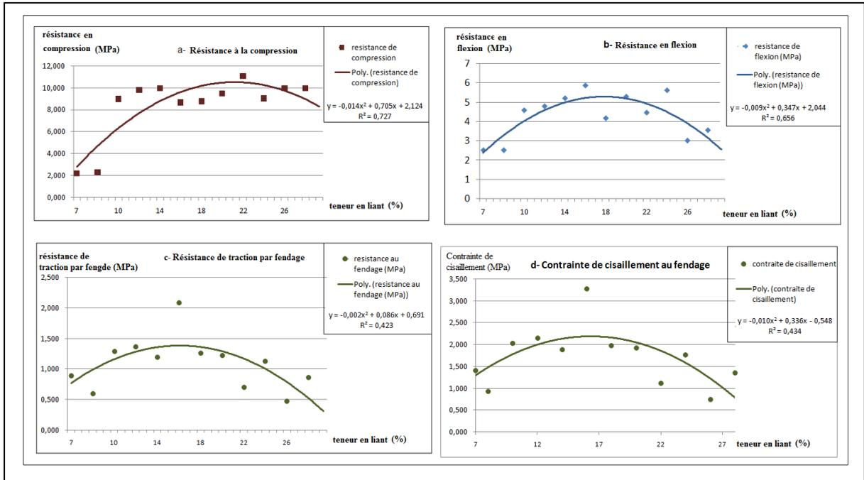
Figure 7 : Résistance en fonction de la teneur en liant
