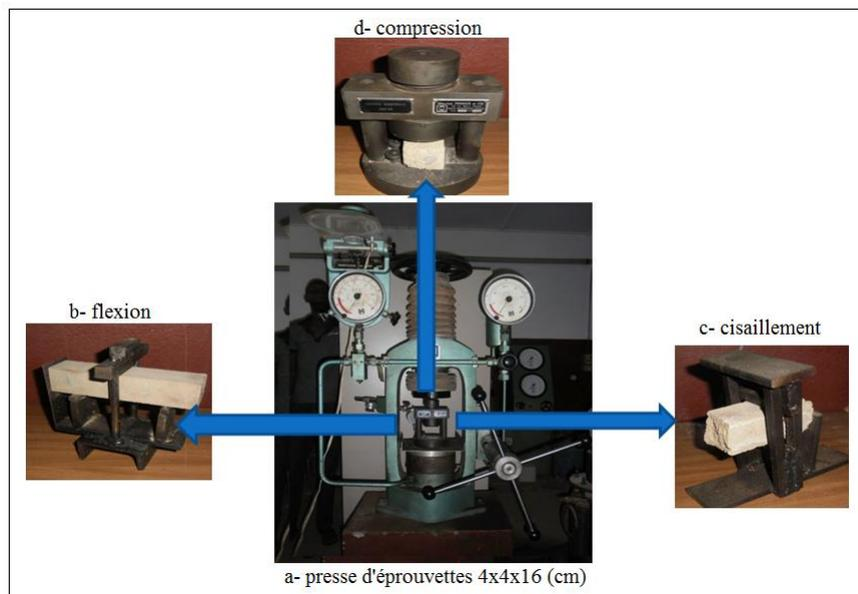
Figure 4 : Dispositif expérimental de détermination de propriétés mécaniques
