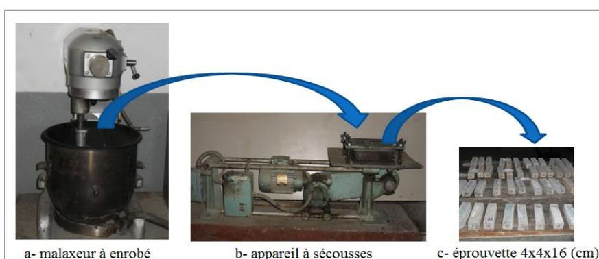
**Figure 3 :** Dispositif expérimental de préparation des éprouvettes
