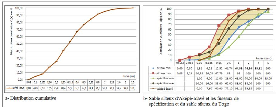
**Figure 5 : Distribution granulométrique du sable utilisé**
