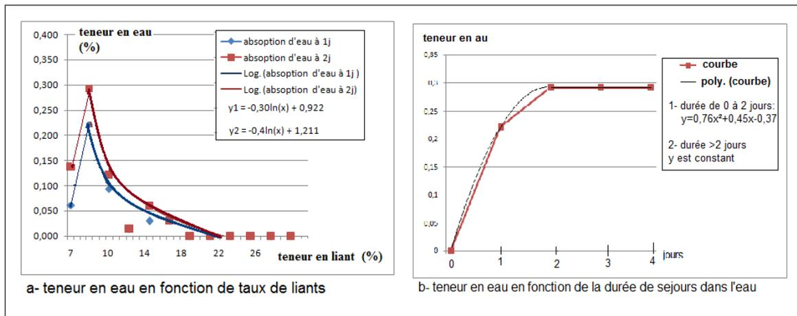
Figure 10 : Absorption d'eau
