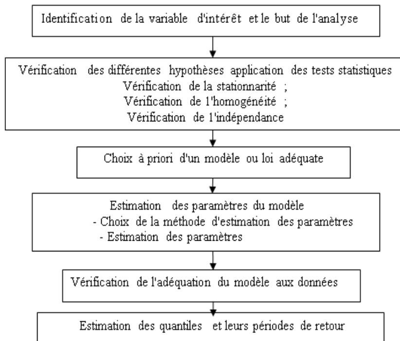
**Figure 3 :** Principales étapes de l'analyse fréquentielle
