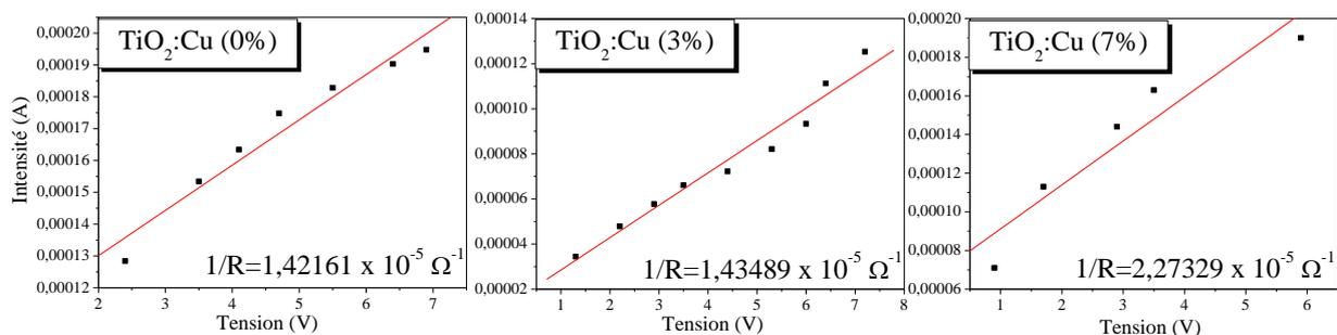
**Figure 8 :** Courbes  $I(V)$  des couches minces en fonction de la tension pour 0%, 3% et 7 % at. Cu
