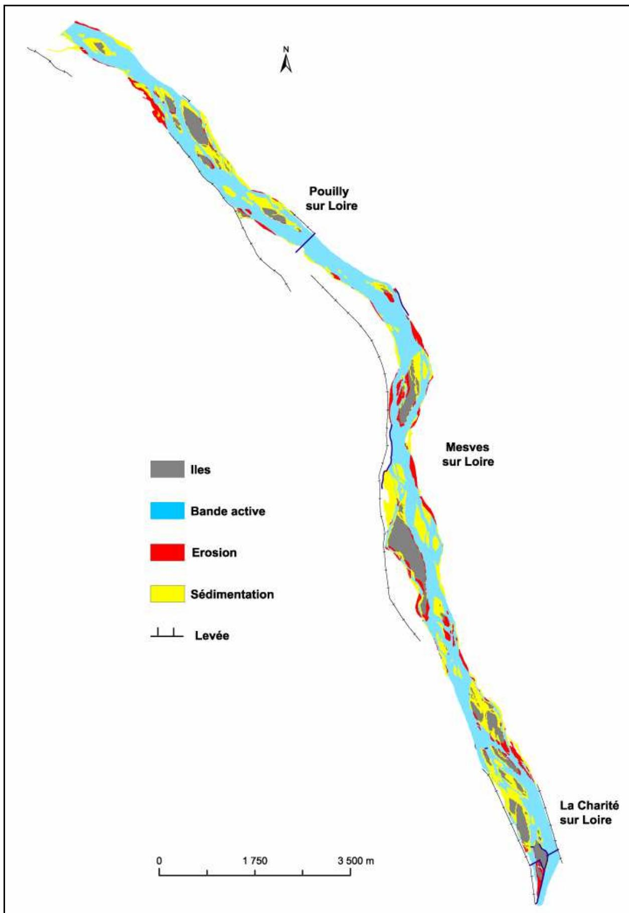
Figure 139 - Cartographie des surfaces érodées et sédimentées de 1960 à 1995 dans Site Atelier 3.
