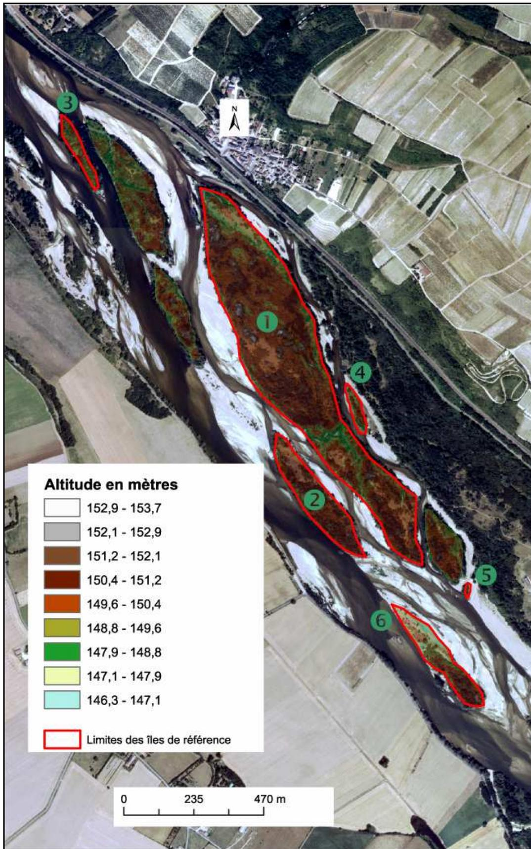
Figure 71 – Construction d'un Modèle Numérique de Terrain ( M.N.T.) à partir des données X, Y et Z du LIDAR de la DIREN Centre. Nous retrouvons les classes de la typologie des îles et leur particularité topographique.
