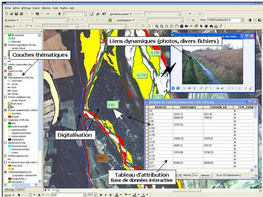
Figure 53 - Interface du S.I.G. sous Arc Gis.
