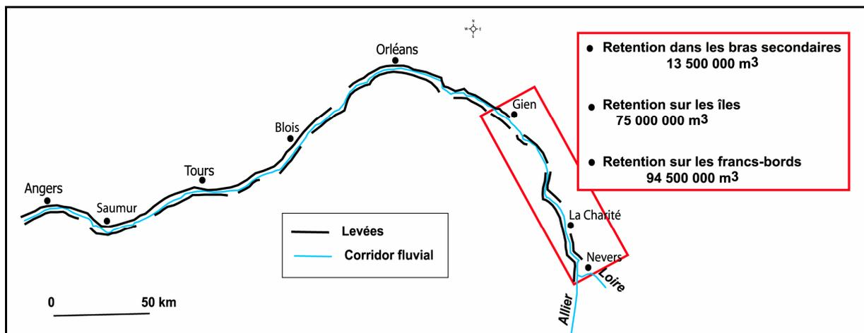
Figure 150 - Estimation des volumes de sédiments piégés, depuis le début du 20<sup>ème</sup> siècle, dans le système anastomosé de la Loire moyenne, du Bec d'Allier jusqu'à Gien.
