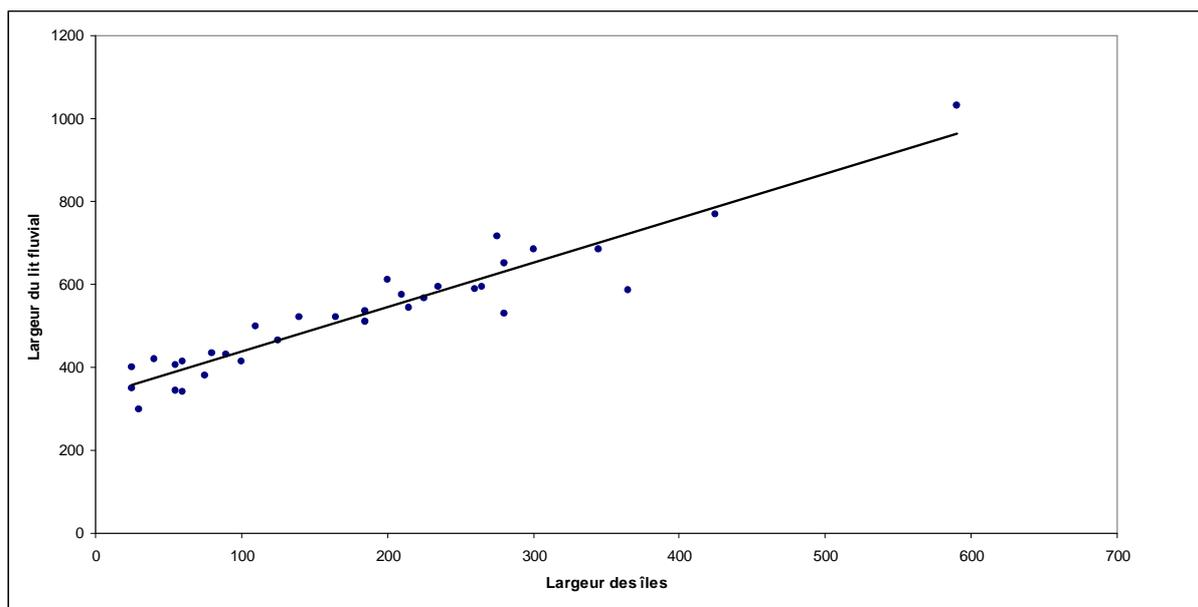
Figure 68 – Corrélation entre la largeur des îles et la largeur du lit fluvial.
