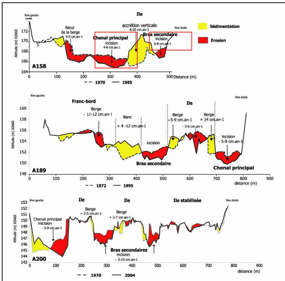
Figure 137 – Profils comparatifs de l'évolution du lit fluvial.
