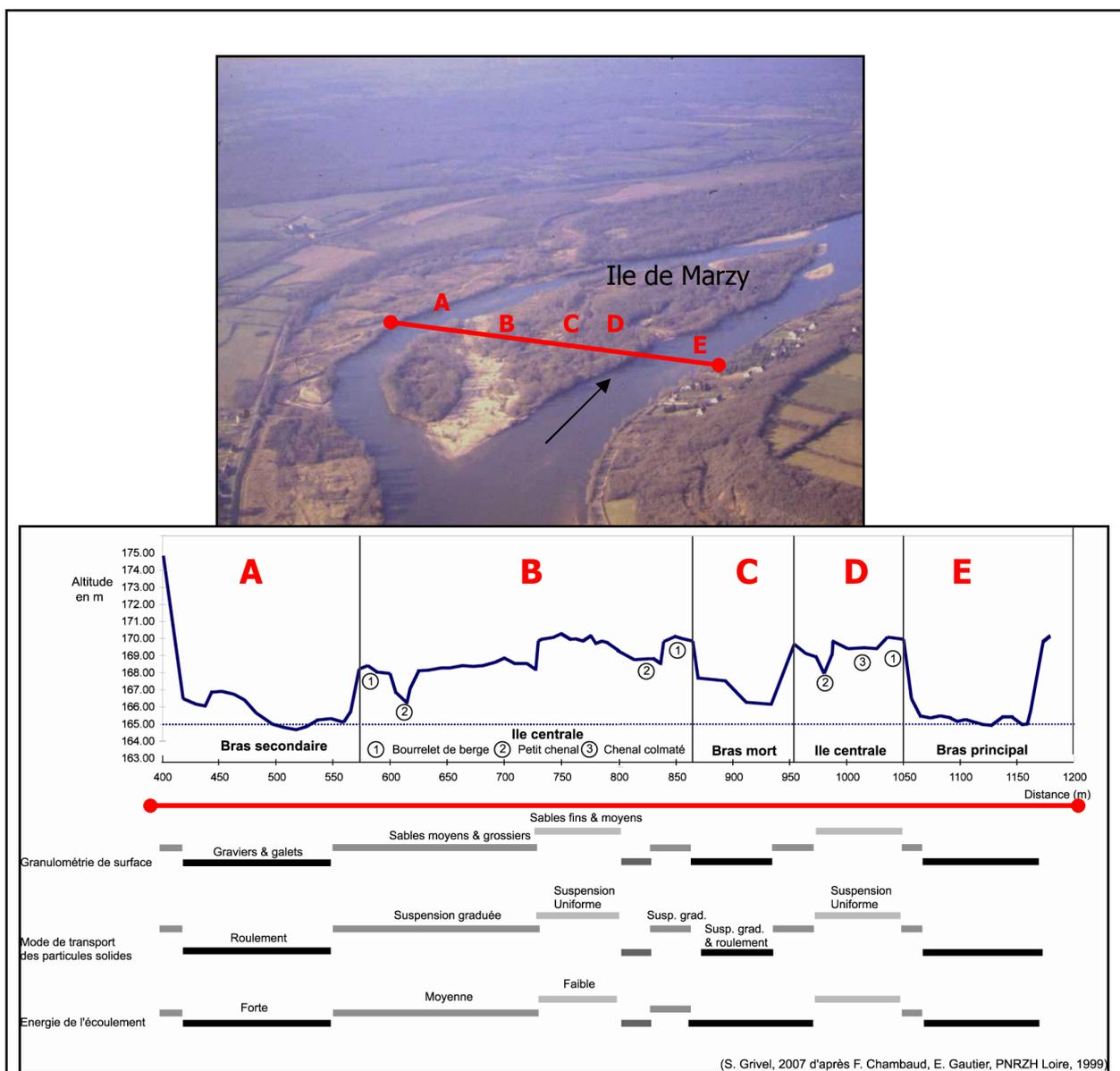
Figure 84 – Caractérisation des dépôts sédimentaires de surface.
