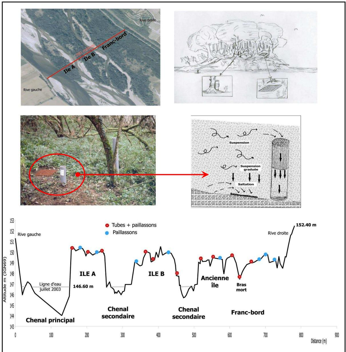
Figure 58 – Le système de pièges à sédiments sur un profil expérimental A200. Il permet de récupérer les matériaux en suspension et en saltation lors des crues. Chaque unité fonctionnelle est équipée de trappes à sédiments et de paillassons. Après chaque événement hydrologique important, ces pièges sont ensuite remplacés et emportés en laboratoire pour analyse.
