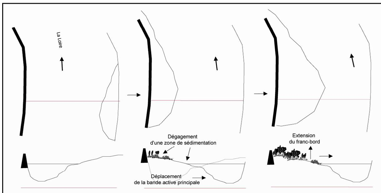
Figure 96 – Extension d'un franc-bord par appui sur une levée. Les levées permettent d'ancrer des zones de sédimentation prédisposées à la colonisation végétale.
