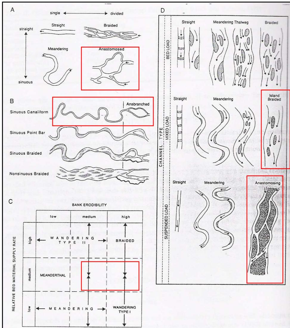
Figure 17 – La place de la Loire des îles dans les grandes classifications des styles fluviaux. Elles se réalisent en fonction de l'indice de sinuosité et du degré de chenalisation (A : Rust, 1978 ; B : Brice, 1984) et en fonction du degré d'érosion des berges et du matériel du lit (C : Carson, 1984). S.A. Schumm (1981) réunit toutes ces variables dans sa classification en tenant compte des formes fluviales. L'anastomose correspond le mieux à la Loire des îles.
