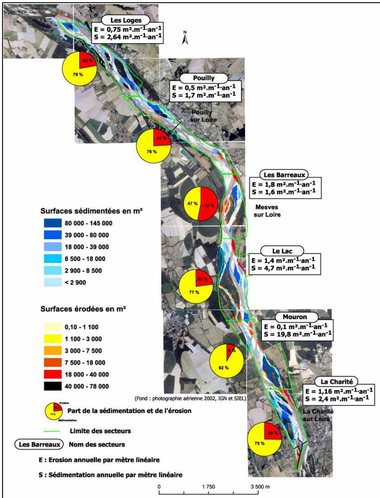
Figure 141 - Bilan des surfaces érodées et sédimentées de 1960 à 1995 dans la Réserve Naturelle du Val de Loire.
