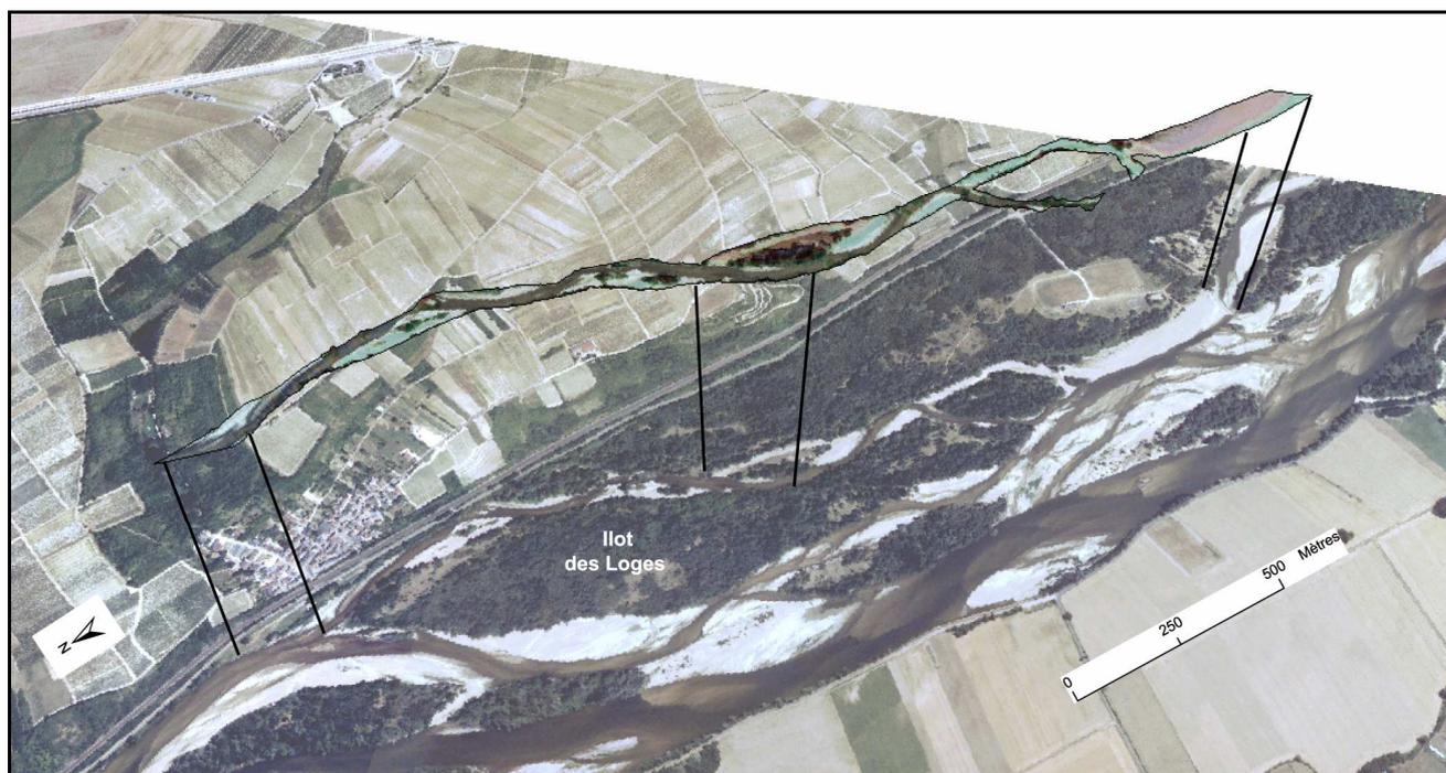
Figure 181 – Drapage de l'image aérienne sur le MNT du bras des Loges (à partir du LIDAR DIREN-Centre).
