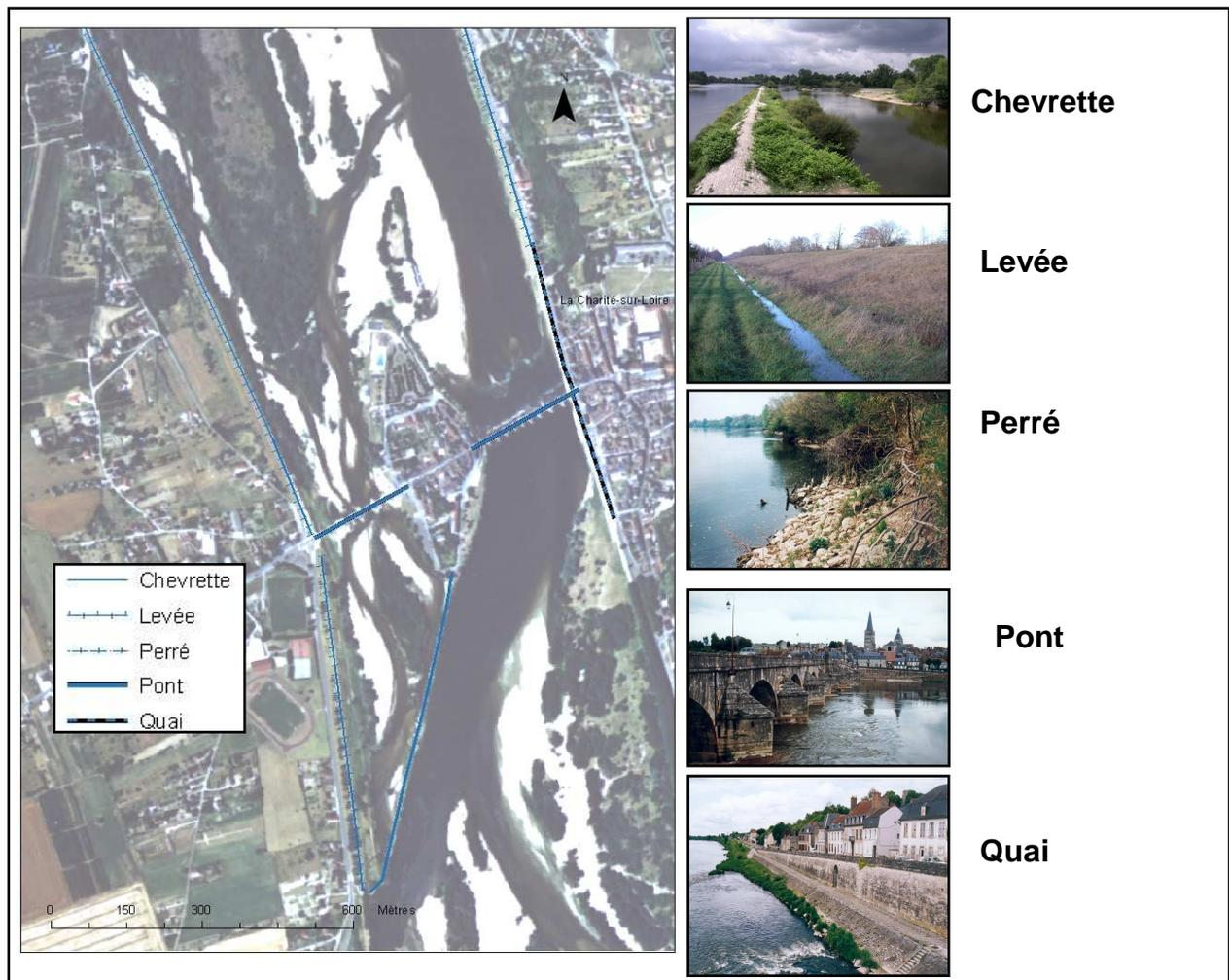
Figure 46 – Différents types d'aménagements fluviaux et leur légende dans le SIG.
