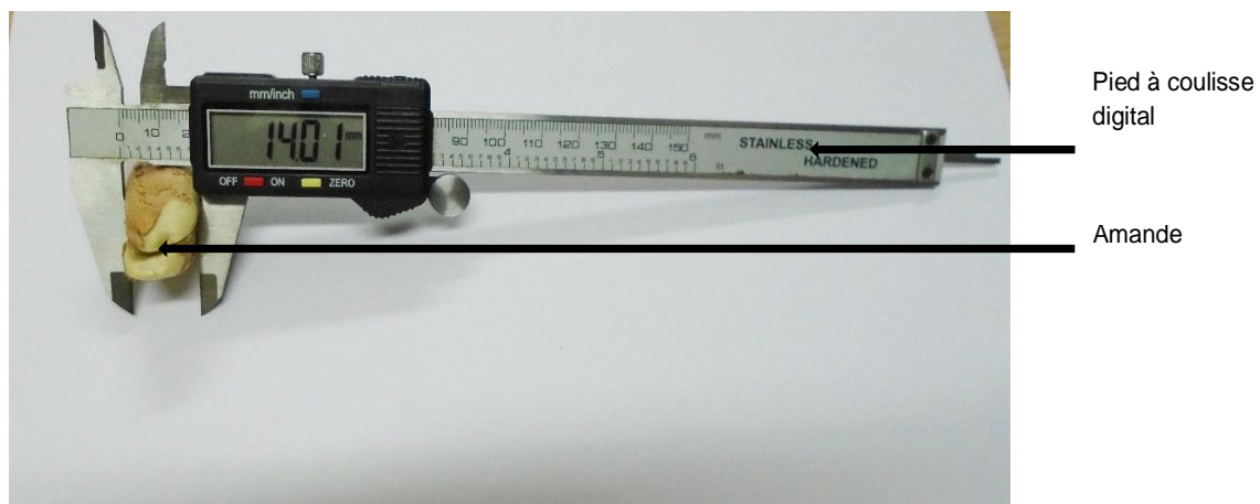
Figure 4 : Aperçu de la technique de mesure des dimensions des amandes de graines de Makoré. Overview of the technique for measuring the dimensions of seed almonds of Makoré.
