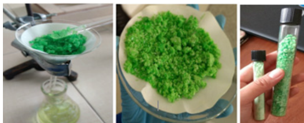
Figura 4. Filtración, secado y almacenado del compuesto de coordinación obtenido: trioxalatoferato (III) de potasio.
