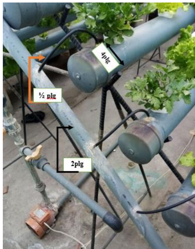
Figura 34-3: Tuberías y dimensiones con que cuenta el sistema hidropónico.
