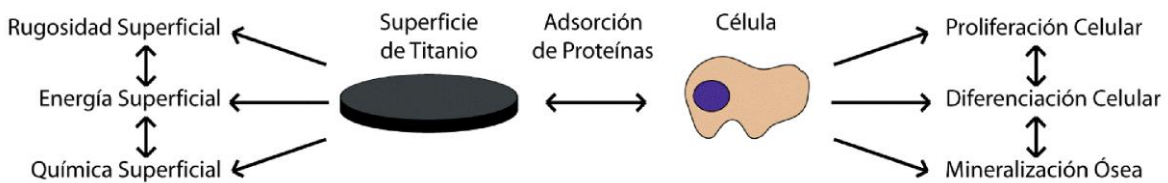
Figura 15. Esquemático de la relación directa e indirecta entre las propiedades superficiales del titanio y los procesos biológicos y celulares que se necesitan para la osteointegración.
