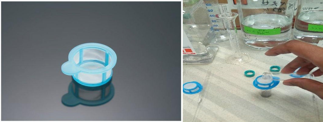
Figura 23. Filtración de las partículas/microtransportadores de titanio.
