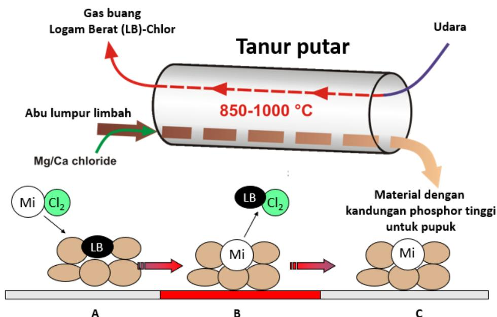
Gambar 1. Ilustrasi proses termokimia untuk mengolah SSA
