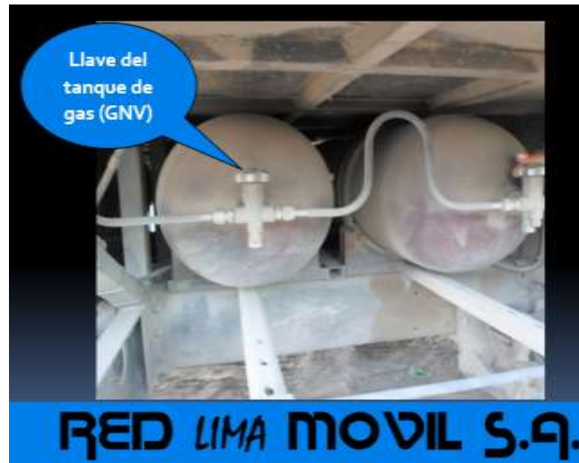
Foto: 4. Tanque de gas de los buses de la empresa de transporte Red Lima Móvil S.A.
