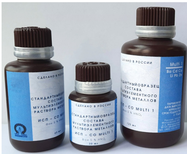
Рис. 2. Стандартный образец состава мультиэлементного раствора металлов ИСП – СО Multi 1
