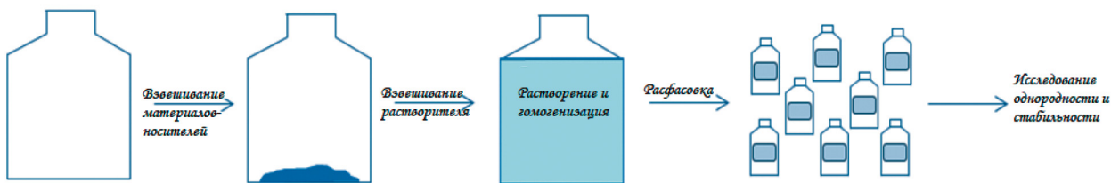
Рис. 1. Общая схема технологии изготовления стандартного образца состава мультиэлементного раствора металлов ИСП – СО Multi 1
