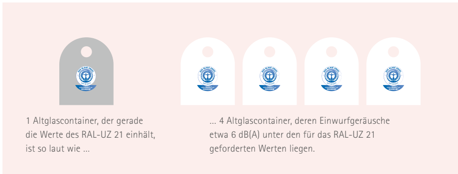
Abb. 19: Unterschiede der Geräuschabstrahlung bei Altglascontainern mit Umweltzeichen
