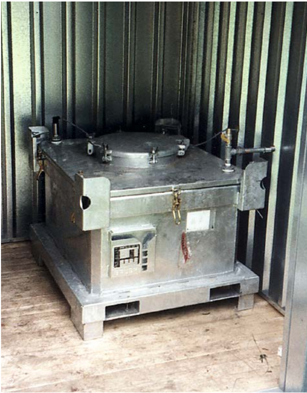
2) Behälter mit zurückgewonnenem Trichlorethen für die Wiederverwendung als Lösungsmittel
