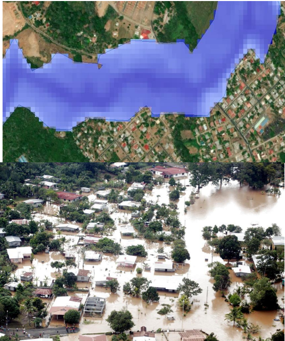
Punto 1. El Trapichito: Barriada el Campesino-Toma de Agua IDAAN Barriada El Campesino Toma de Agua Tanto la simulación como la fotografía muestran la salida del río de su cauce natural.
