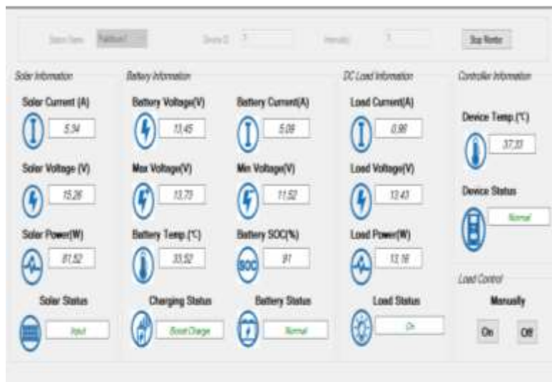
Gambar 4. Hasil pengukuran menggunakan komunikasi RS485
