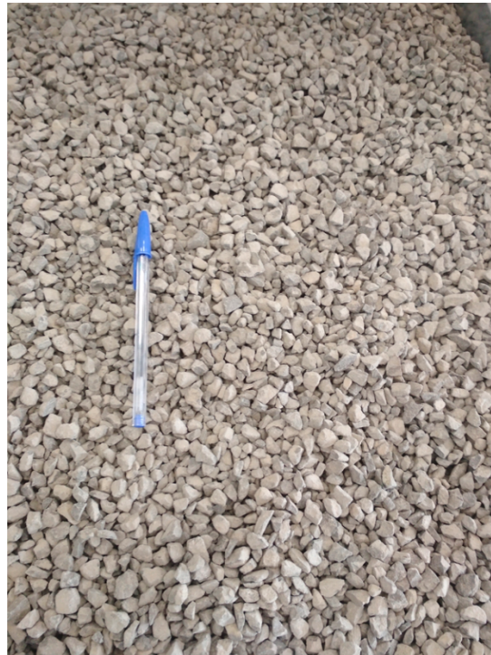
Figura 2. Agregado usado na produção do concreto permeável
