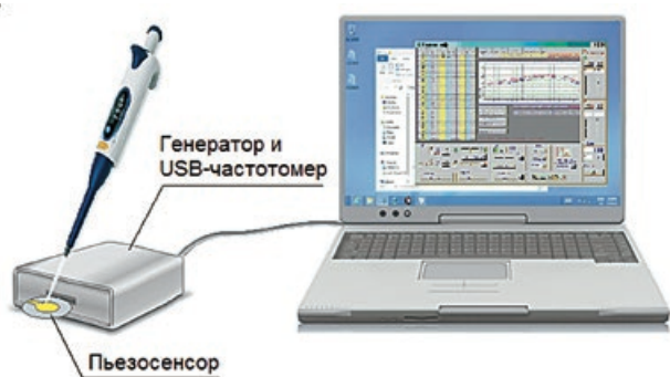
Рис. 1. Схема установки определения концентрации формальдегида.
