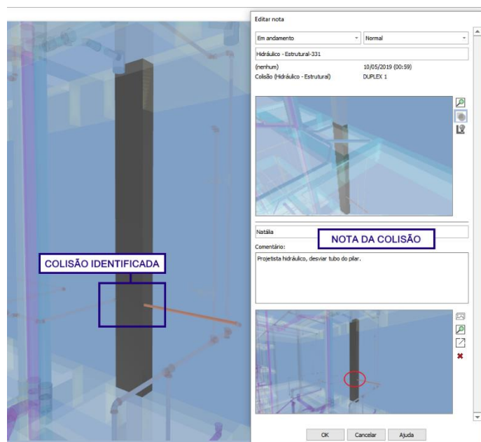
Figura 6 - Ferramenta de "detecção de colisão" [16]
