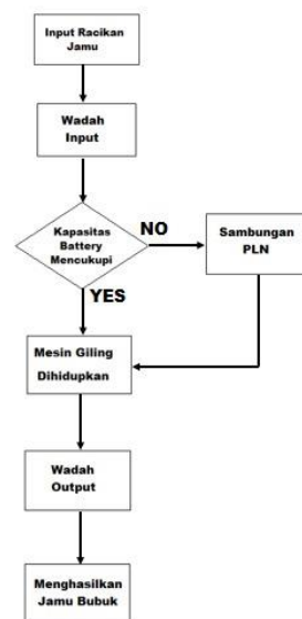
Gambar 5. Diagram Alir Gambaran Umum Sistem Kerja Mesin Giling
