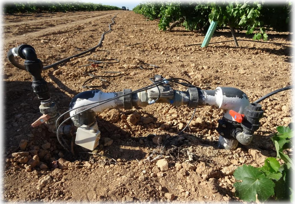
Figura 11. Imagen de la conexión del prototipo con el sistema de riego.
