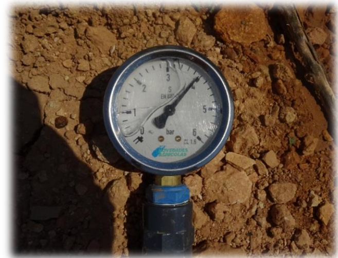
Figura 14. Imagen del manómetro para controlar la presión de trabajo.
