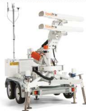
Figura 59. GroundProbe – Equipos de radar utilizados en el tajo Tomado de Compañía “X”, Actualizado - 2019
