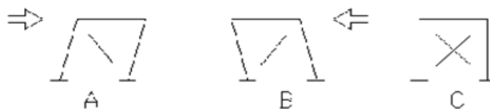
Fig.3.6 Desplazamiento lateral de la estructura
