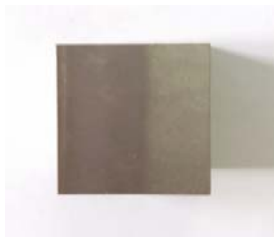
Gambar 3. Spesimen untuk uji komposisi kimia.
