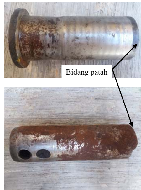
Gambar 2. Contoh produk pin yang patah
