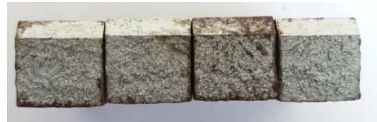
Gambar 12. Permukaan patahan hasil uji impak.
