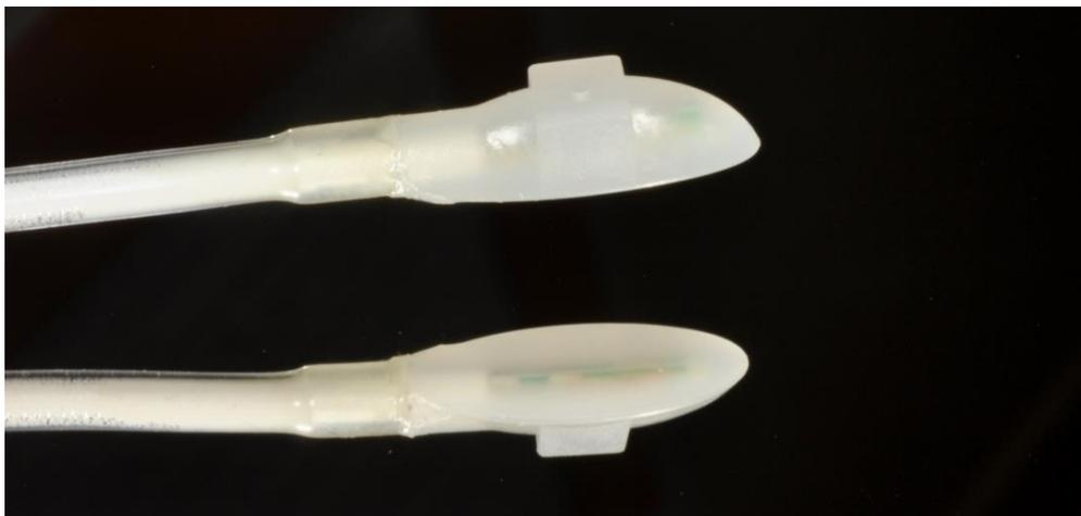
Abbildung 4-2: Marker Tools mit *6DOF*-Sensortechnologie, einem Gewicht von 3 Gramm und einer Größe von ca 15 mm (Klebefläche).
