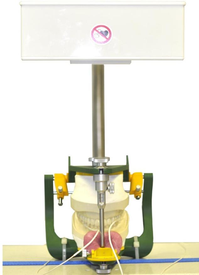
**Abbildung 4-8: Fixierter Artikulator unter dem FGD des DMD-Systems®. Das FGD hatte ca. 25 cm Abstand zu den MTs.**
