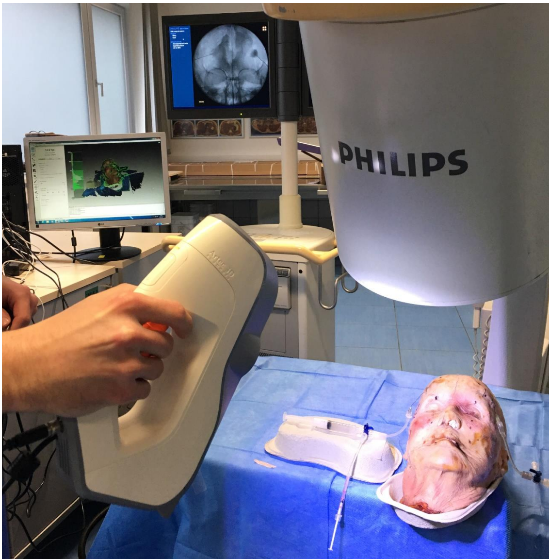
Abbildung 4: Handgeführter 3-D Scanner Eva der Firma Artec 3D (Luxemburg). Hier exemplarisch im Einsatz zur 3-D Volumetrie im Rahmen der Arbeit von Publikation 1.
