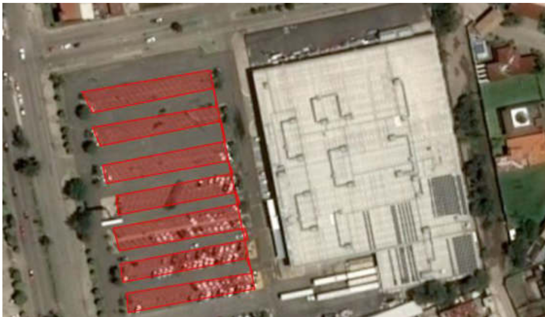
Figura 5.1 Vista del estacionamiento, en dirección norte-sur, mostrando (en rojo) las áreas de instalación para los módulos fotovoltaicos.
