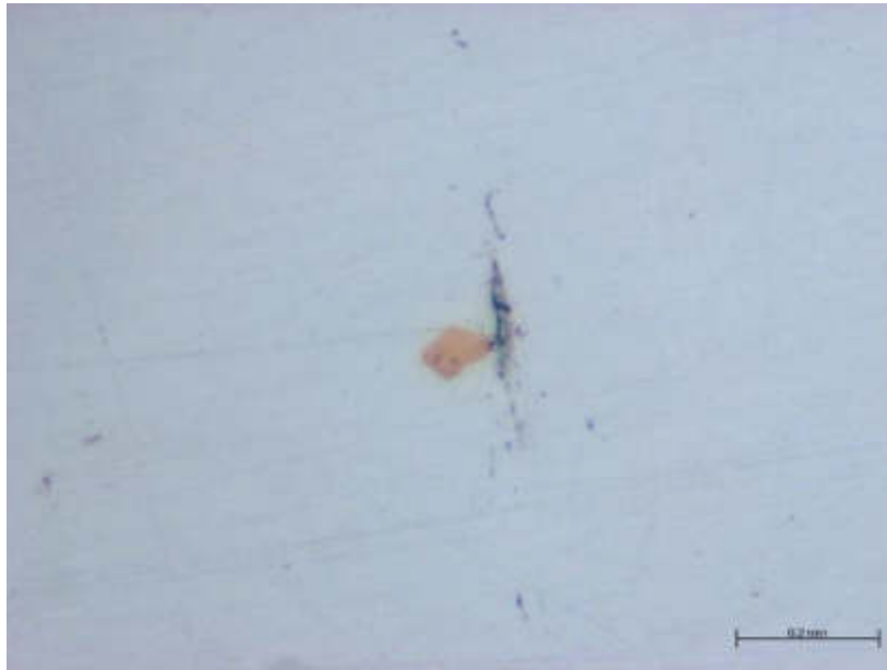
Figura 4.10. Imagen metalográfica de la muestra 1TI a 50x, donde se expone una microgrieta aledaña a lo que parece ser un precipitado.
