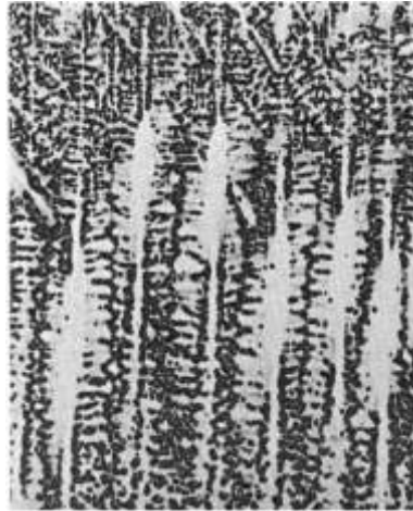
Figura 2.13 Estructura dendrítica de DS MaeM246. Las regiones blancas son dendritas cristalinas con regiones interdendríticas negras visibles debido a las diferencias en las concentraciones químicas destacadas por ataque químico (McLean, 1983).
