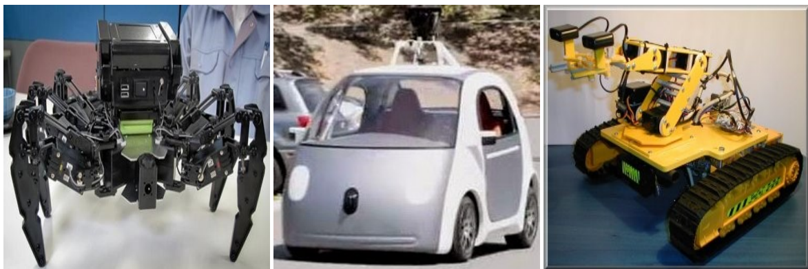
(a) Robot con patas (b) Robot con ruedas (c) Robot de oruga
