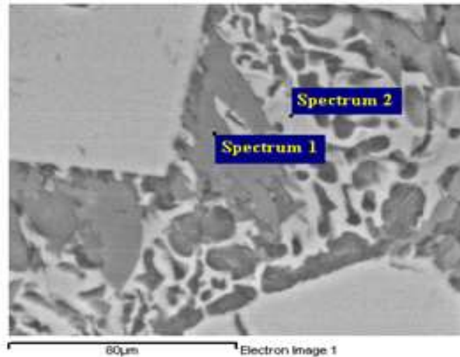
Figura 44.- Micrografía de cara caliente de composición 2. MEB 1600 X.
