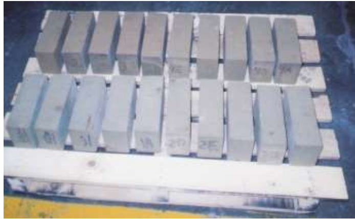
Figura 15.- Ladrillos refractarios sinterizados.
